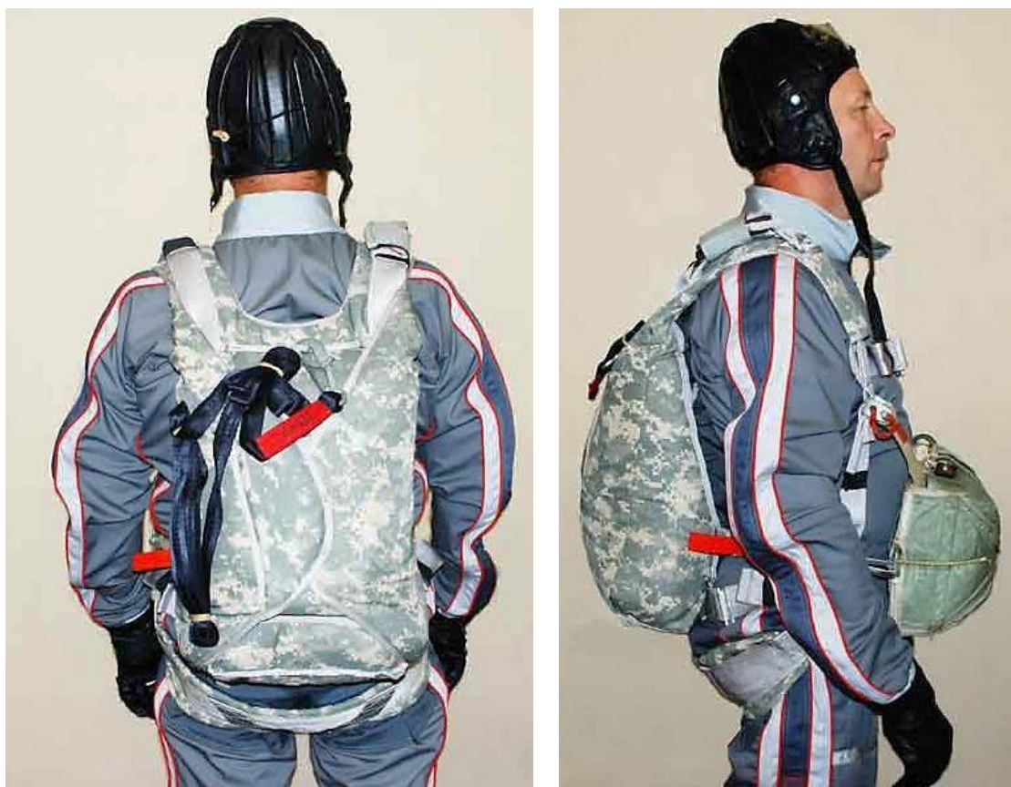
Рисунок 1 – Общий вид ПС П1-У с ПЗ типа 3-5 (в одном из вариантов применения)
