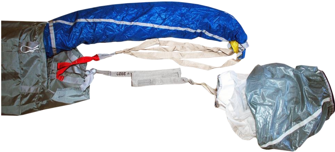
Рисунок Д.36а – Надевание камеры на купол
