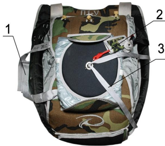
Рисунок В.47 – Укладка купола ВП
