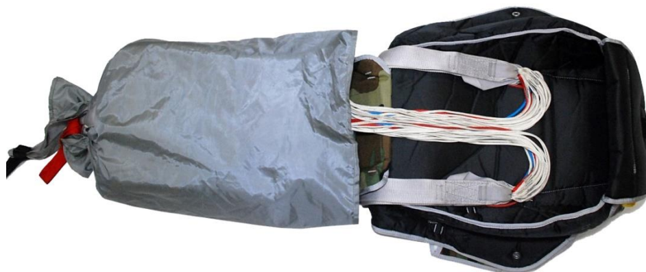
Рисунок А.45 – Укладка СК на дно ранца
