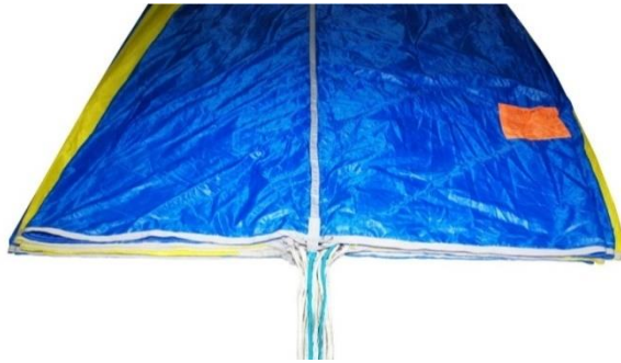
Рисунок В.33 – Укладка купола ОП
