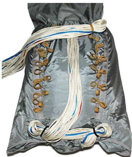
Рисунок Д.39 – Укладка строп
