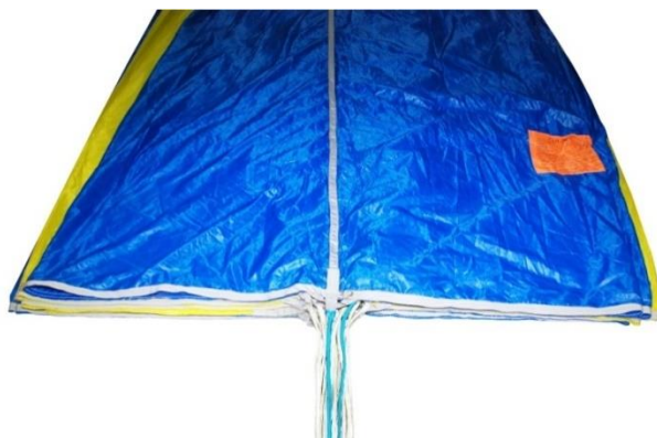
Рисунок Д.33 – Укладка купола ОП
