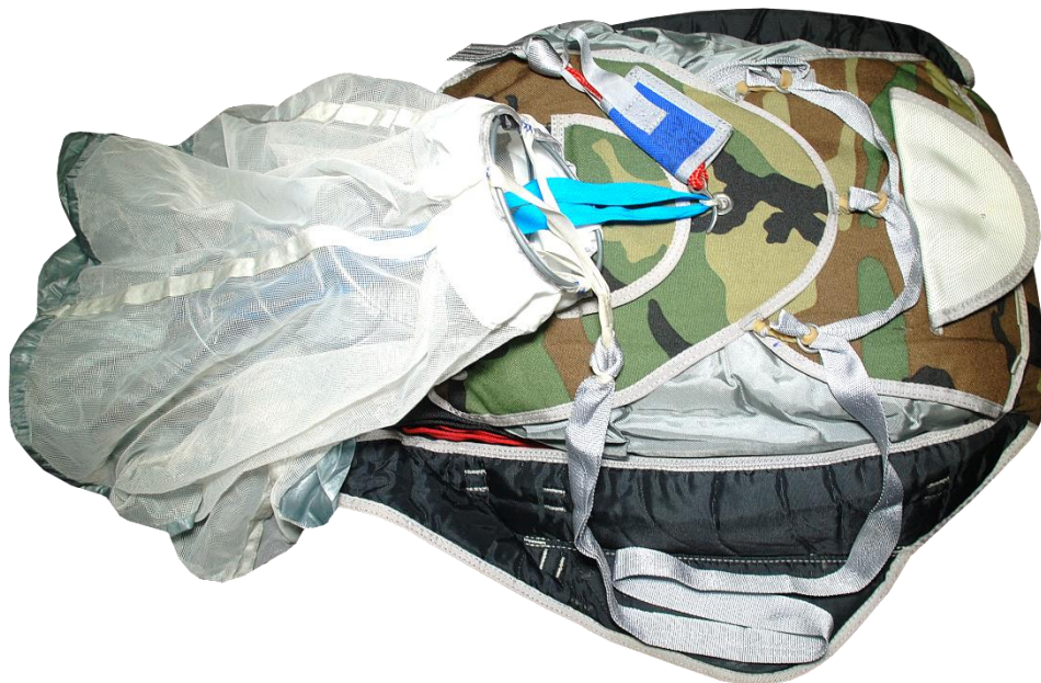
Рисунок В.45 – Затяжка ранца
