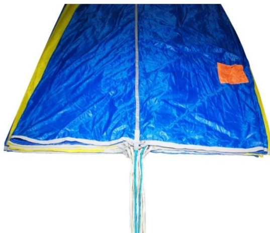
Рисунок В.30 – Укладка купола ОП
