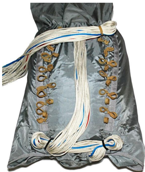
Рисунок В.39 – Укладка строп
