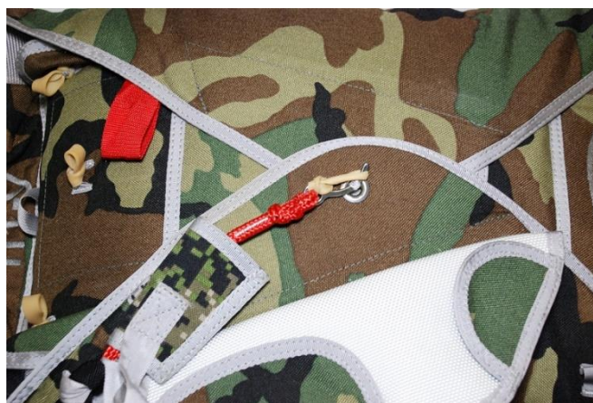
Рисунок А.48 – Зачехловка ранца
