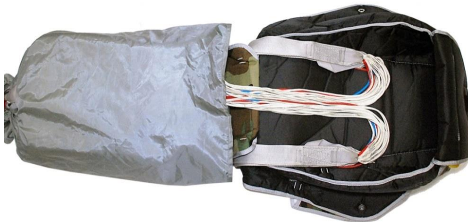
Рисунок Д.42 – Укладка СК на дно ранца
