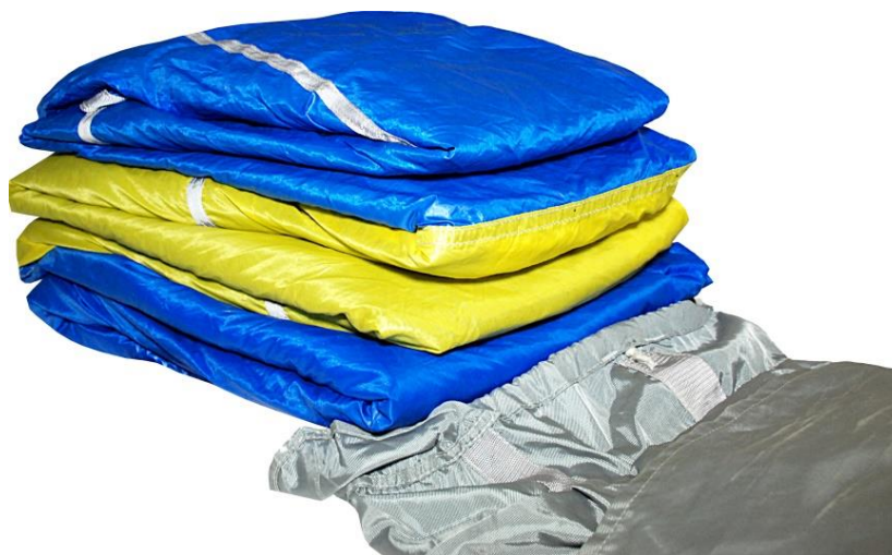
Рисунок А.38 – Укладка купола парашюта
