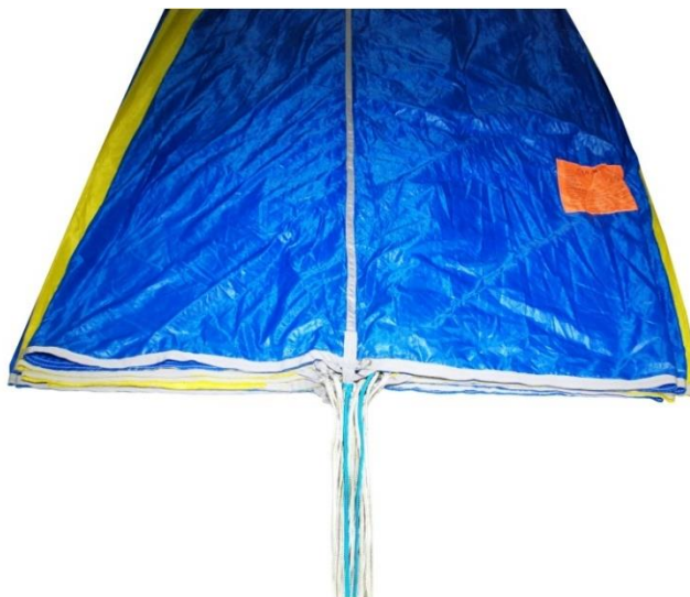
Рисунок А.30 – Укладка купола ОП
