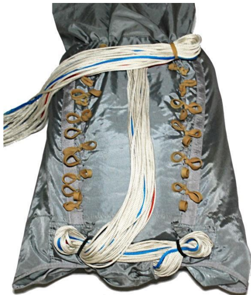
Рисунок А.42 – Укладка строп
