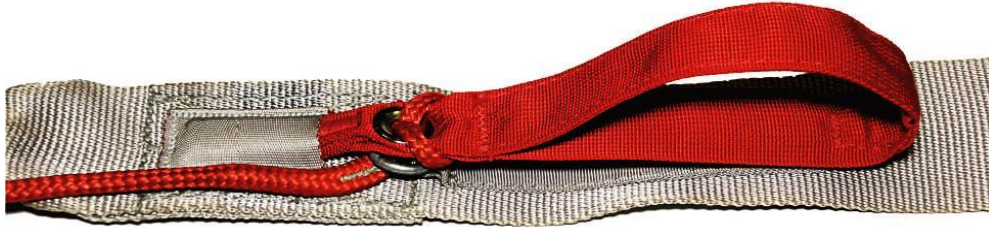
Рисунок 26 – Монтаж звеньев управления
