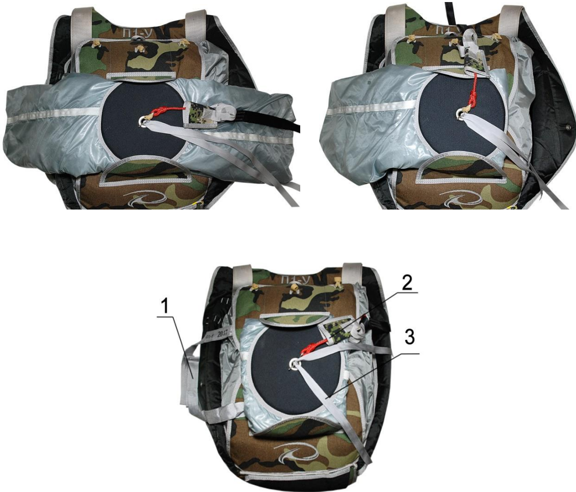
Рисунок Б.47 – Укладка купола ВП
