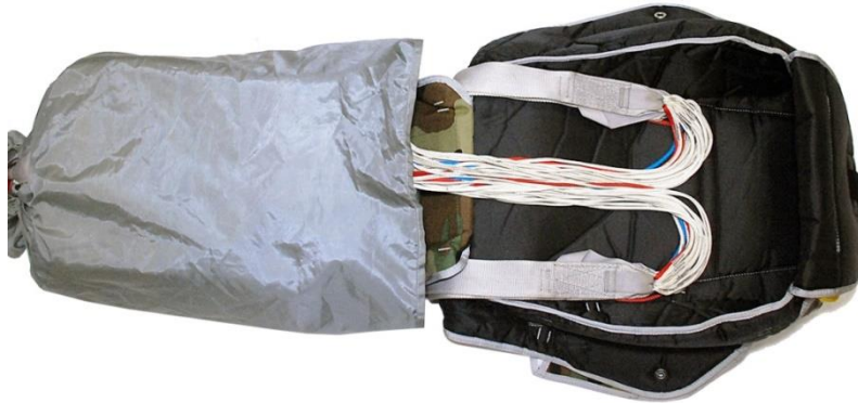
Рисунок В.42 – Укладка СК на дно ранца
