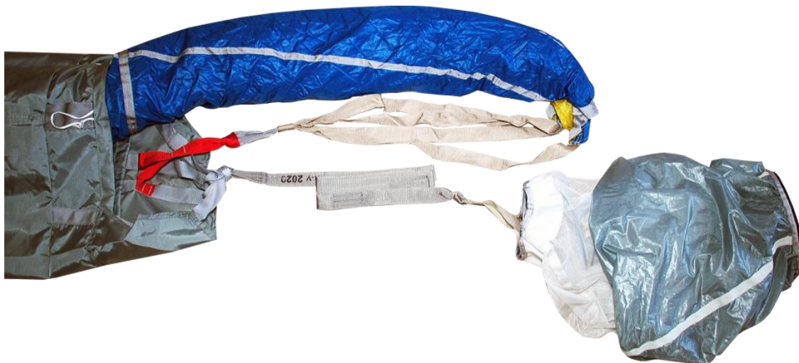
Рисунок В.36а – Надевание камеры на купол
