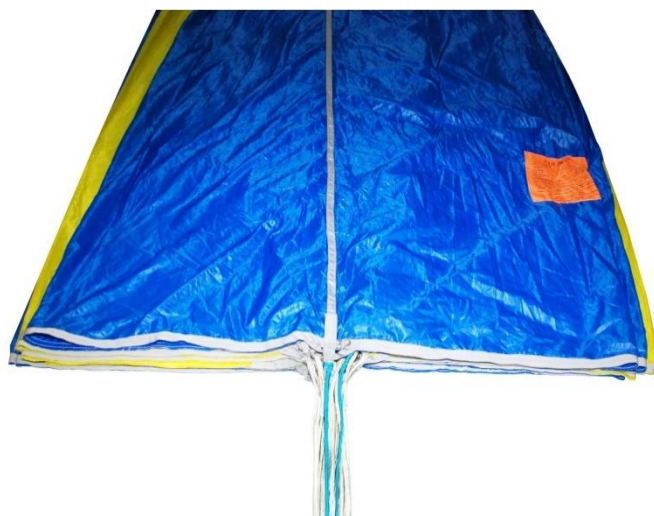
Рисунок А.33 – Укладка купола ОП
