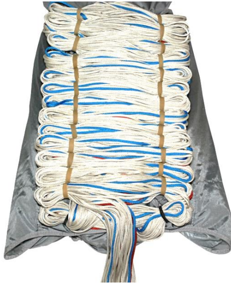
Рисунок В.40 – Укладка строп
