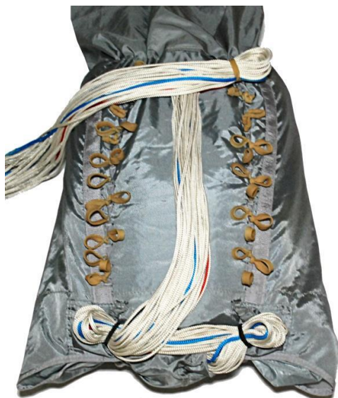
Рисунок Б.39 – Укладка строп
