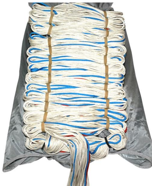
Рисунок Д.40 – Укладка строп
