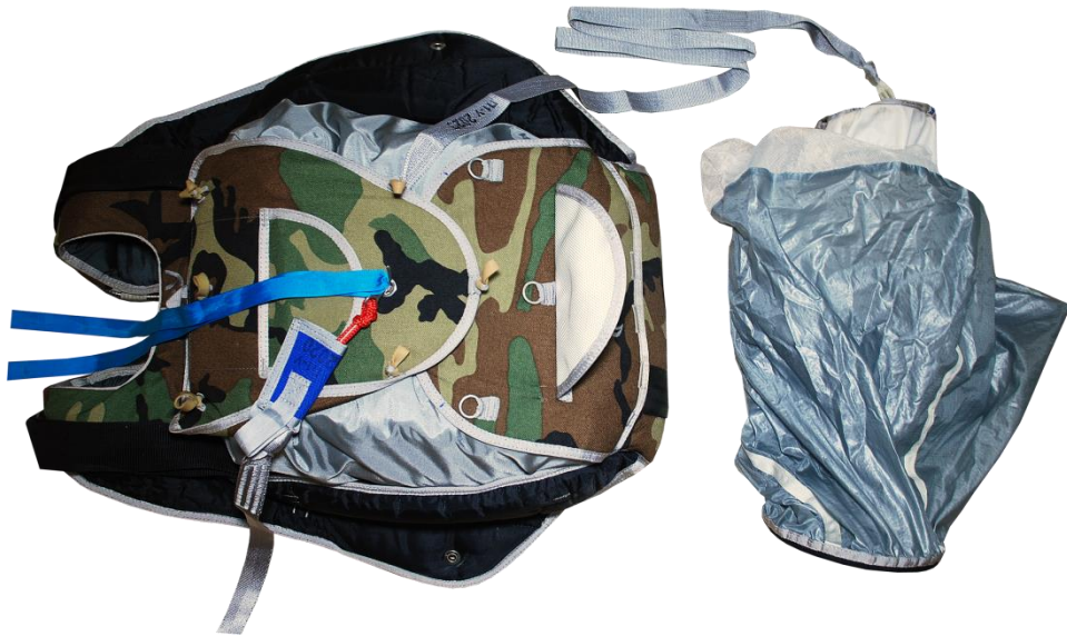
Рисунок В.44а – Затяжка ранца
