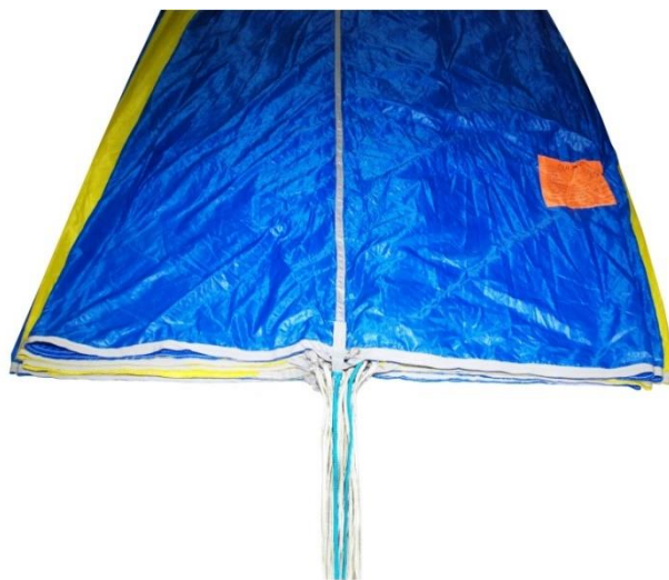
Рисунок Д.30 – Укладка купола ОП
