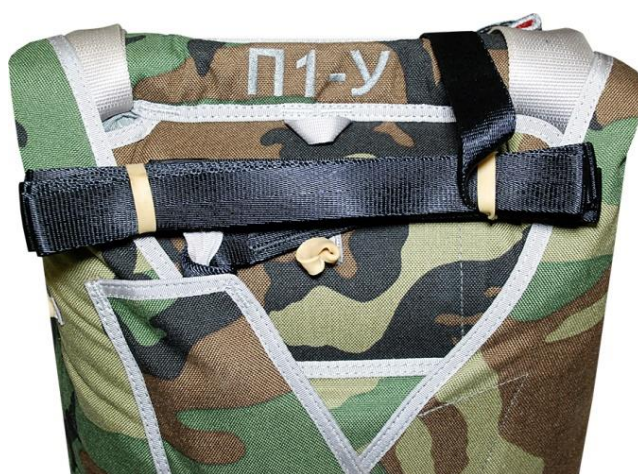
Рисунок Б.53 – Монтаж вытяжного звена на верхний клапан ранца
