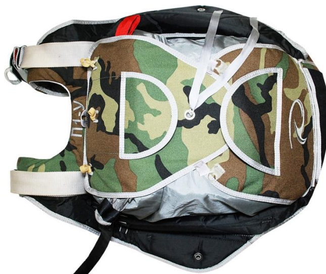
Рисунок А.47 – Затяжка ранца
