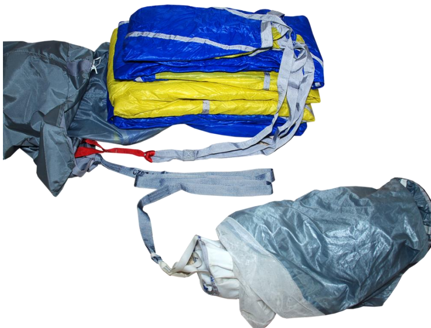
Рисунок Д.36г – Укладка купола парашюта
