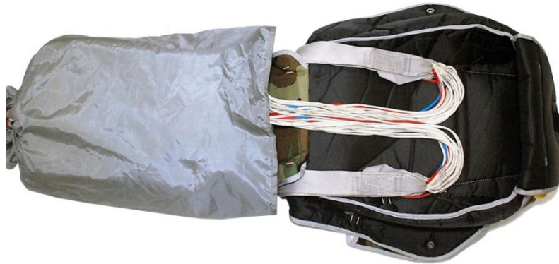
Рисунок Б.42 – Укладка СК на дно ранца
