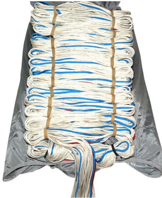
Рисунок Б.40 – Укладка строп
