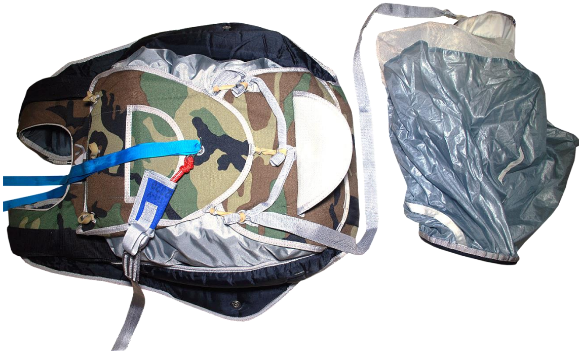
Рисунок В.44в – Затяжка ранца
