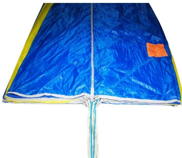
Рисунок Б.30 – Укладка купола ОП
