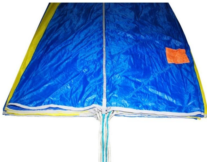
Рисунок Б.33 – Укладка купола ОП
