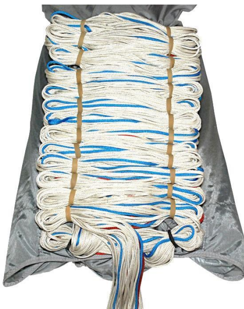
Рисунок А.43 – Укладка строп
